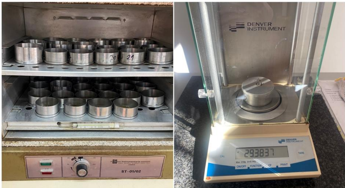
Slika 7 Postupak sušenja i vaganja sjemenki i pogače za određivanje udjela vode
