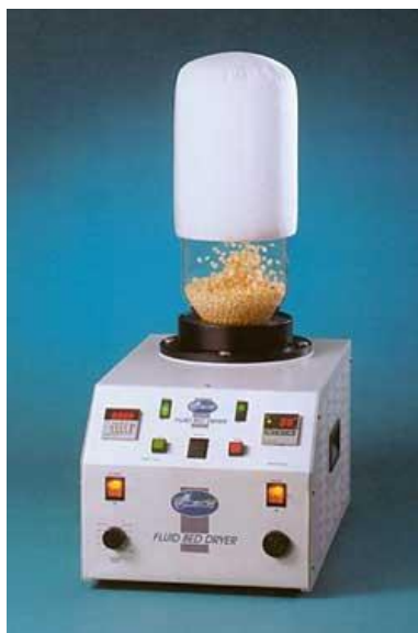
Slika 4 Prikaz konvekcijskog sušionika s fluidizacijom
