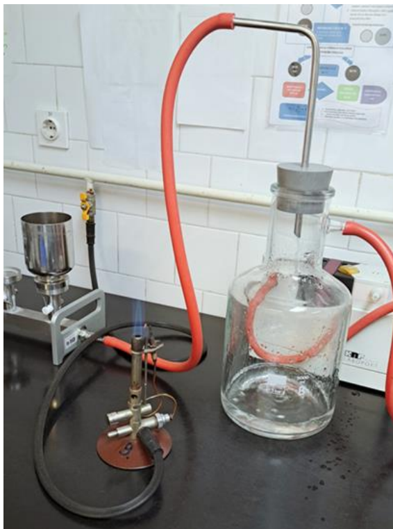
Slika 8 Uređaj za membransku filtraciju Zavoda za javno zdravstvo Bjelovarsko-bilogorske županije
