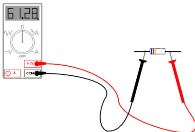
**Slika 7.** Mjerjenje otpora pomoću univerzalnog instrumenta
