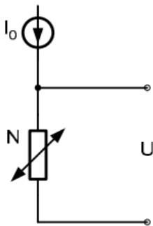
**Slika 12.** Napon  $U$  proporcionalan je oporu NTC otpornika
