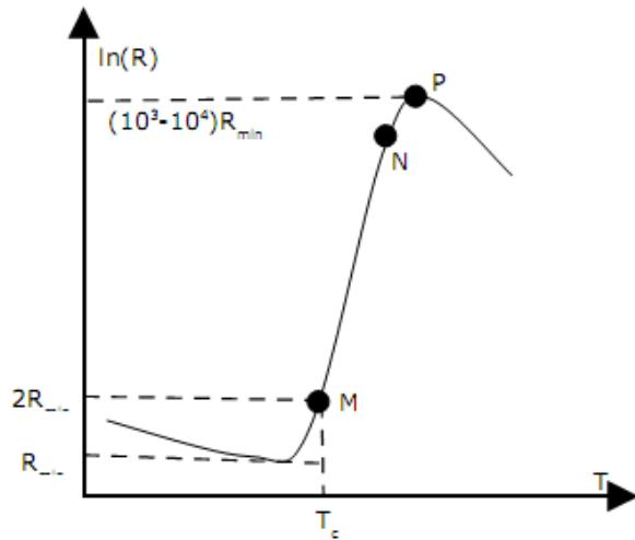
Slika 15.  $R$ - $T$  karakteristika PTC otpornika
