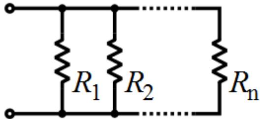
**Slika 2.** Paralelni spoj otpora
