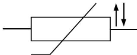
Slika 10. Simbol NTC otpornika
