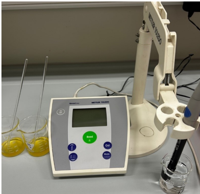
Slika 3 Mjerenje električne vodljivosti konduktometrijski
