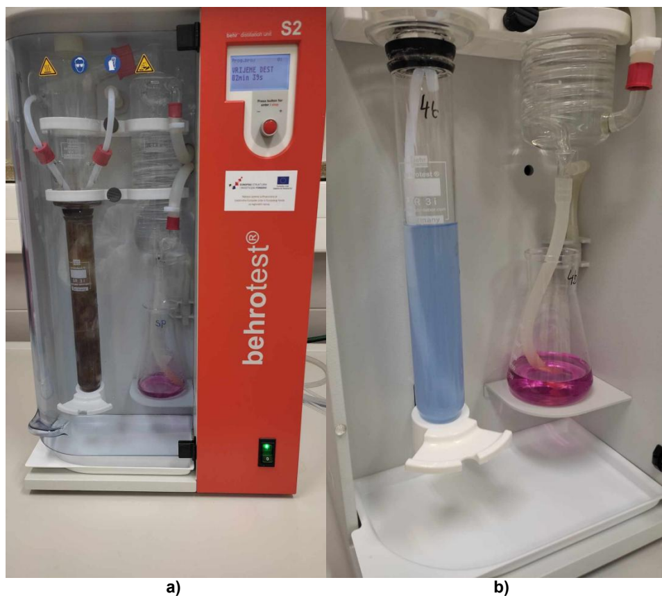
Slika 20 Destilacija: a) vrijeme destilacije b) završen postupak destilacije (Potočar, 2023)
