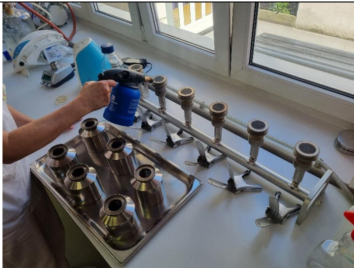
Slika 5: Višestruki sustav za membransku filtraciju
