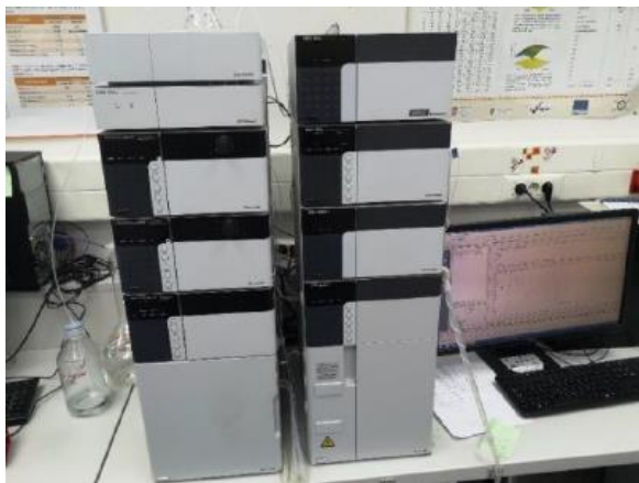
Slika 19 UHPLC - visokotlačni tekućinski kromatograf (Nexera XR, Shimadzu, Japan)
