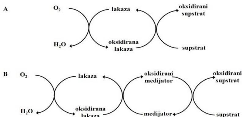
Slika 3 Shematski prikaz redoks ciklusa oksidacije lakazom (A) bez i (B) uz medijator (Jurinjak Tušek, 2013)
