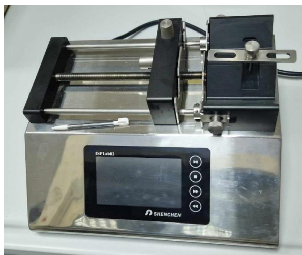
Slika 18 Pumpa za mikroreaktorski sustav (SHENCHEN ISPLab02, Baoding Shenchen Precision Pump Co., Ltd., Hebei, Kina)
