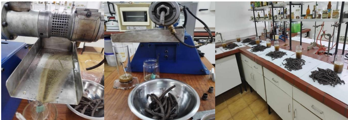
Slika 20 Proces proizvodnje sirovog ulja i pogače sa pužnom prešom
