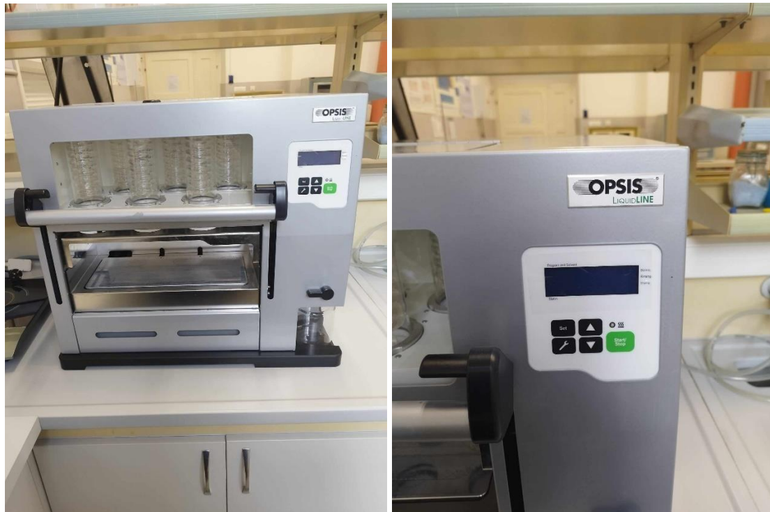
Slika 24 Uređaj za ekstrakciju ulja - SoxROC Extraction Unit
