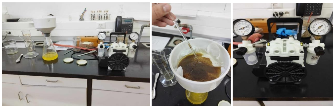
Slika 21 Proces filtracije sirovog ulja
