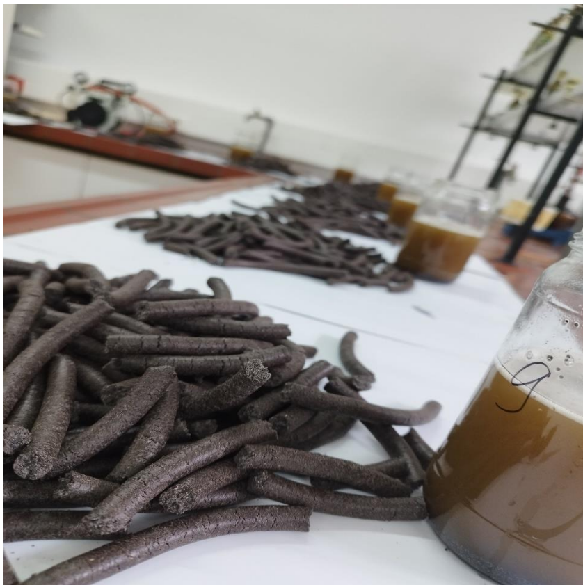
Slika 12 Pogača dobivena prešanjem sjemenki maka
