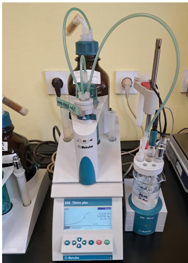
Slika 16 Titrator za određivanje sadržaja anionskih tenzida (METROHM TITRINO PLUS 848)
