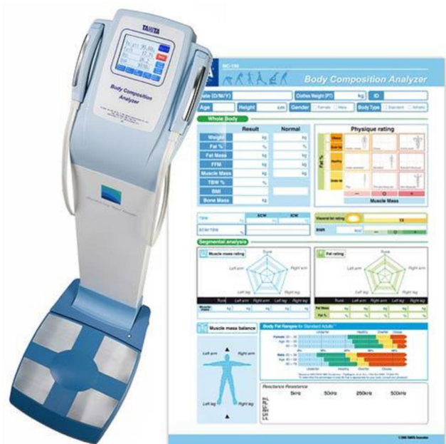
Slika 57 Analizator sastava tijela, Tanita, MC-180-MA Uređaj za određivanje sastava tijela i stanja uhranjenosti u vlasništvu Prehrambeno-tehnološkog fakulteta Osijek
