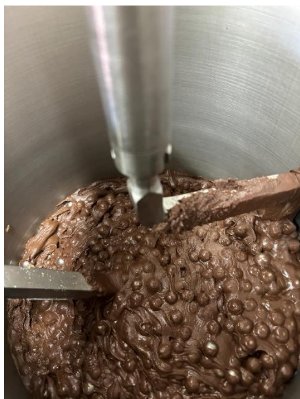
Slika 32 Unutrašnjost kugličnog mlina tijekom izrade kakao krem-proizvoda
