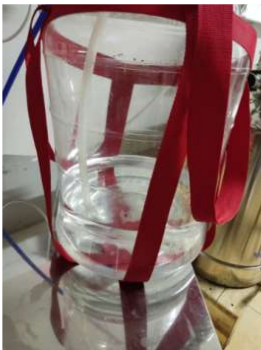
Slika 18 Tekućina nakon „stripping run-a“
