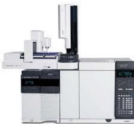
Slika 6 Plinski kromatograf s masenim detektorom (Web 3)
