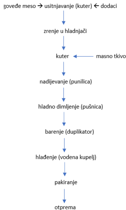
Slika 4. Shematski prikaz tehnološkog postupka proizvodnje obarenih kobasica od toplog mesa (Živković, 1983.)
