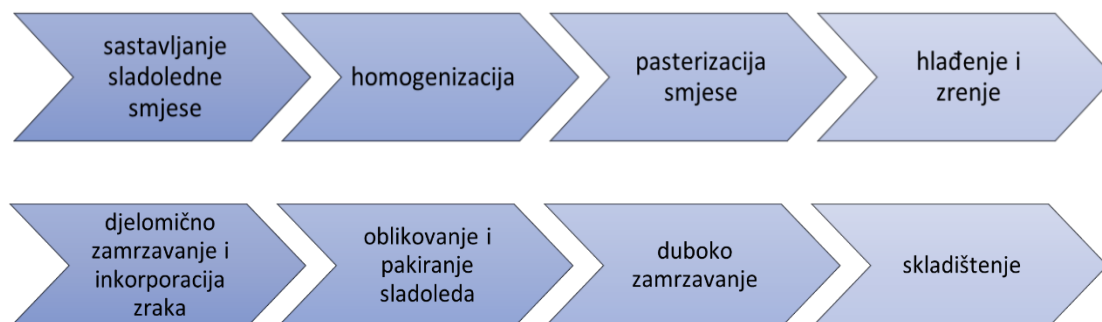
Slika 1 Shematski prikaz postupaka prve i druge faze proizvodnje sladoleda (Goff, 2011)
