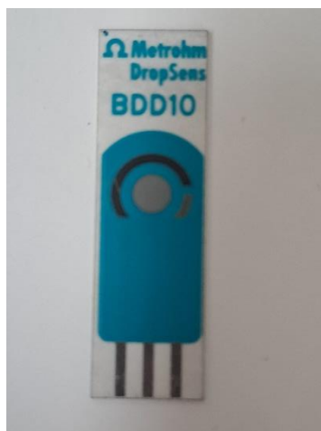
Slika 8 Komercijalna jednokratna dijamantna elektroda dopirana borom (vlastita fotografija)
