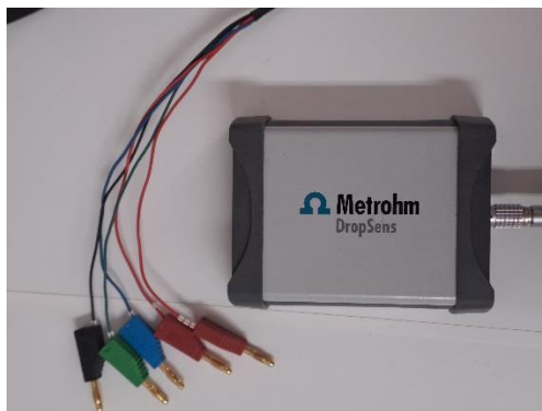
Slika 7 Potenciostat/ galvanostat/ impedancijski analizator \mu Stat-i 400 (vlastita fotografija)
