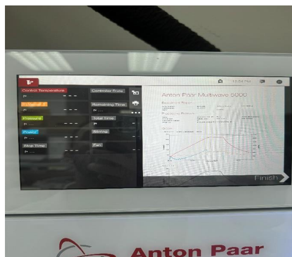
Slika 6 Sučelje za upravljanje uređajem za digestiju
