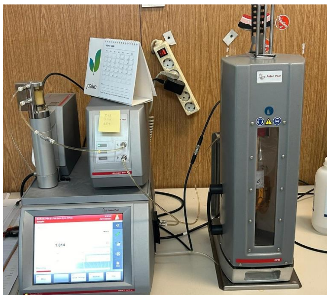
Slika 12 Uređaj za analizu piva DMA 4500 M proizvođača Anton Paar (vlastita arhiva)
