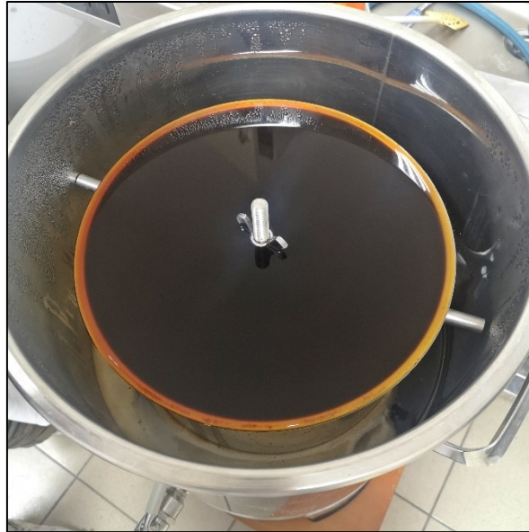
Slika 7 Preljevanje sladovine tijekom ukomljavanja (izvor: privatna arhiva)
