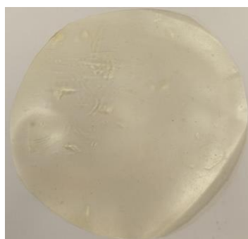
Slika 17. Materijal pripremljen od 5 % škroba s dodatkom vodenog ekstrakta jabuke, te s 2,5 % glicerola, s upotrebom Petrijeve zdjelice većih dimenzija
