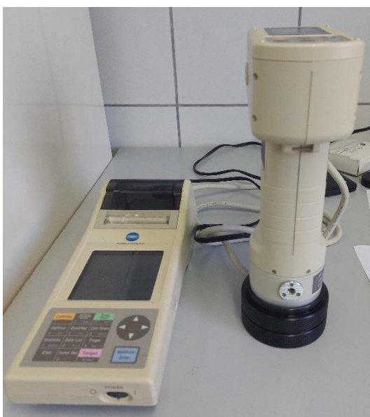
Slika 16 Kromametar Konica Minolta CR-400
