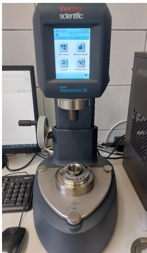
Slika 20 Rotacijski reometar HAAKE Viscotester iQ
