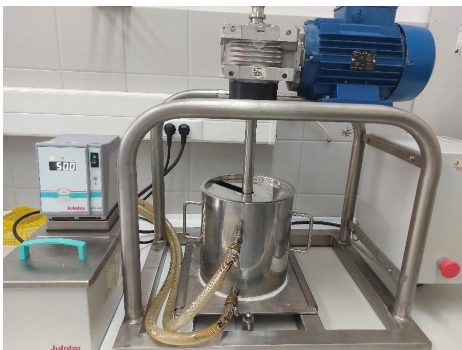
Slika 14 Laboratorijski kuglični mlin
