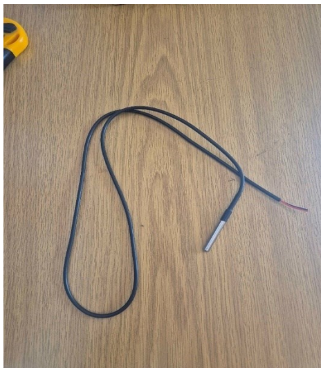
Slika 11 DS18B20 u zaštitnoj košuljici (osobna arhiva)
