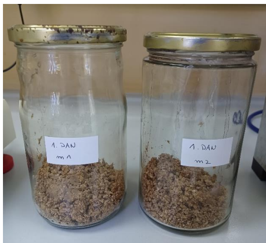
Slika 1 Pivski trop pripremljen za proces fermentacije na čvrstim nosačima (osobna arhiva).
