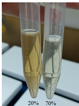
Slika 18 Supernatanti nastali pročišćavanjem sirovog ekstrakta enzima endo-1,4- \beta -ksilanaze hladnim acetonom (uvjeti ekstrakcije: jednostupanjsko, T(\text{aceton}) = -20^{\circ}\text{C} , t = 24 h, T(\text{taloženje}) = 4^{\circ}\text{C} , centrifugiranje pri 9000 rcf, 15 minuta) (osobna arhiva).
