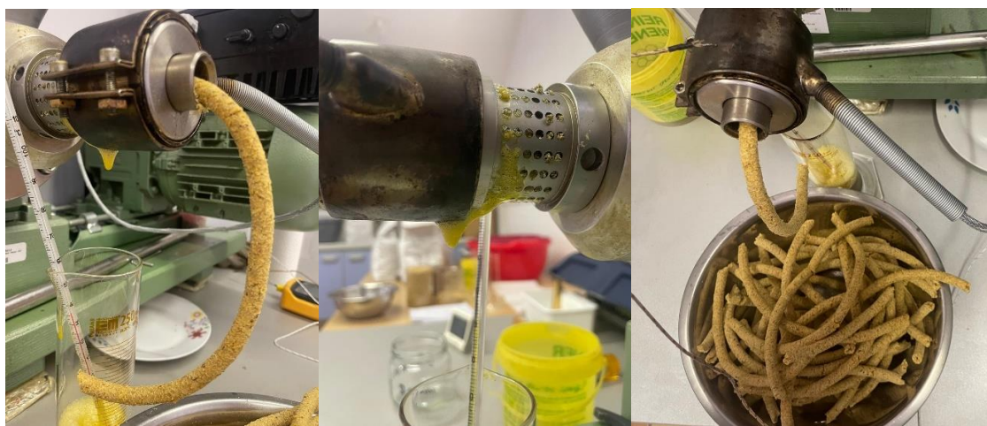
Slika 13 Proces hladnog prešanja soje
