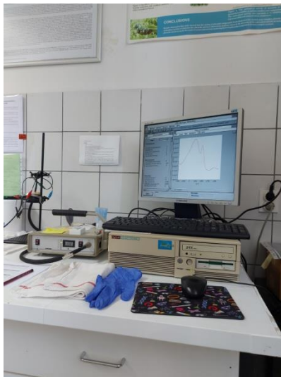
Slika 12 Kompjutorski kontroliran potencijostat/galvanostat
