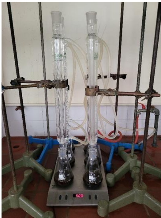
Slika 5 Aparatura za ekstrakciju taloga kave pri sobnoj temperaturi
