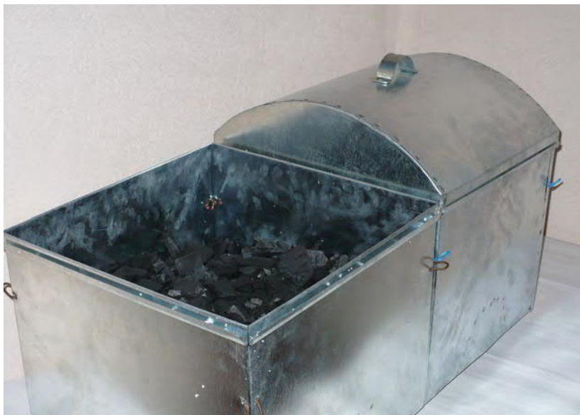
Slika 8. Prikaz modela kontejnera s drvenim ugljenom.
