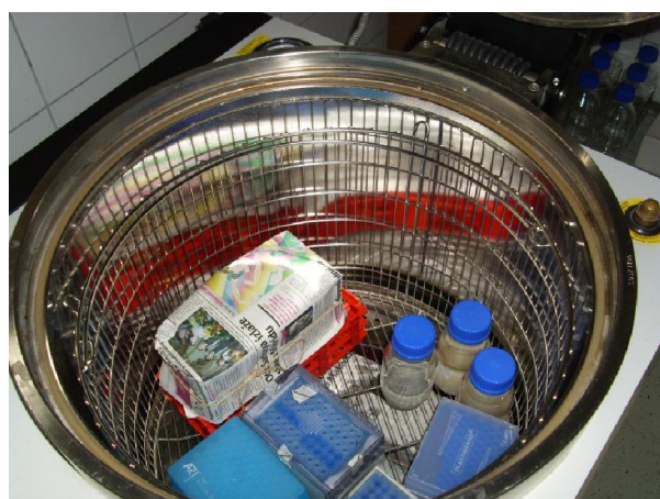
Slika 12 Sterilizacija u autoklavu agara u epruvetama i tipseva za pipetiranje
