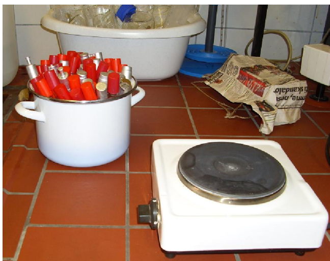
Slika 13 Zagrijavanje steriliziranog agara u vodenoj kupelji na 100 °C
