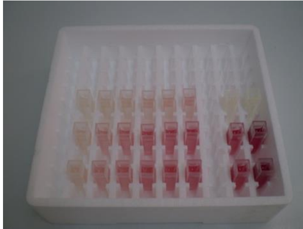
Slika 4 Uzorci spremni za mjerenje apsorbancije
