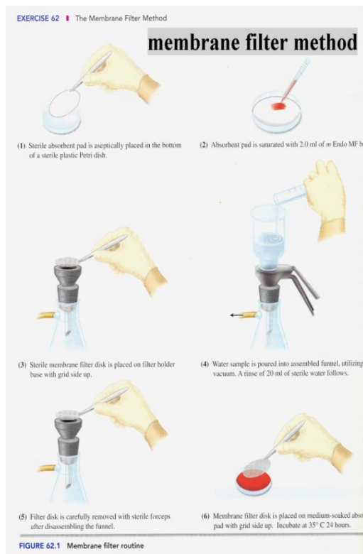
Slika 3. Metoda određivanja živih bakterija pomoću membranske filtracije
