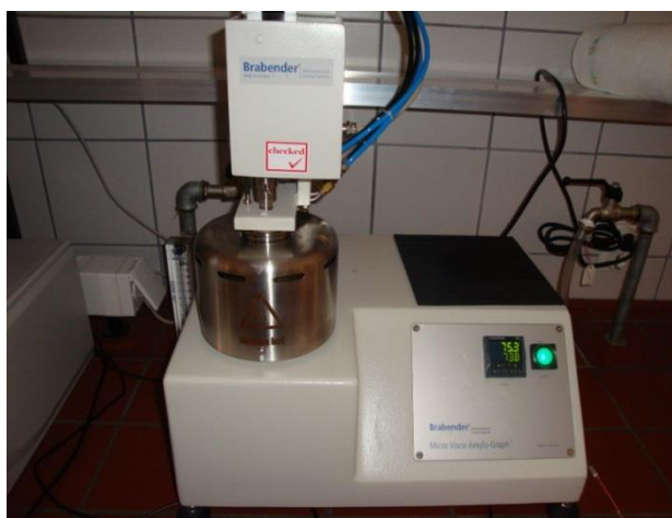
Slika 9 Brabenderov Mikro visko-analyzer (Jozinović, 2011)
