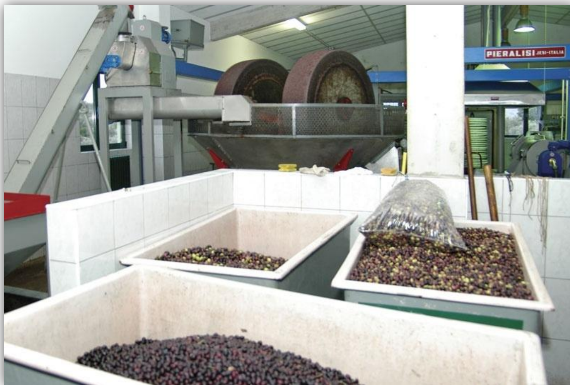
Slika 1 Pranje plodova maslina u prvoj fazi proizvodnje maslinovog ulja (Zlokić, n.d.).
