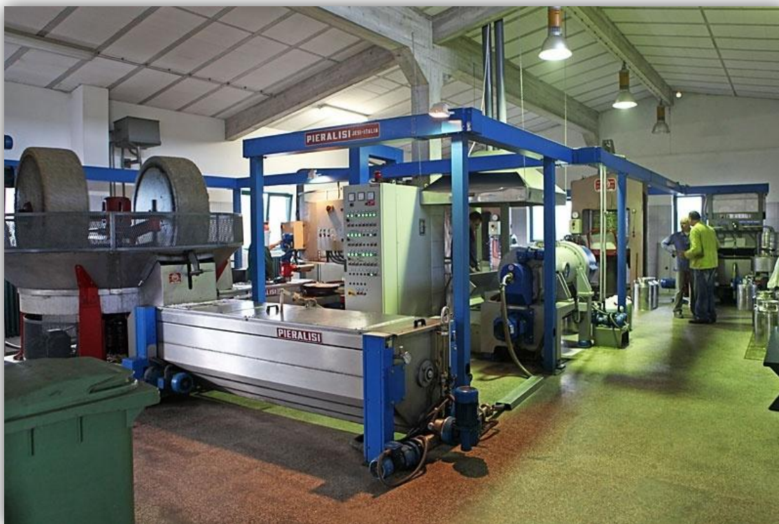
Slika 2 Dio proizvodnog pogona prerade maslina sa kamenim mlinom (Zlokić, n.d.).
