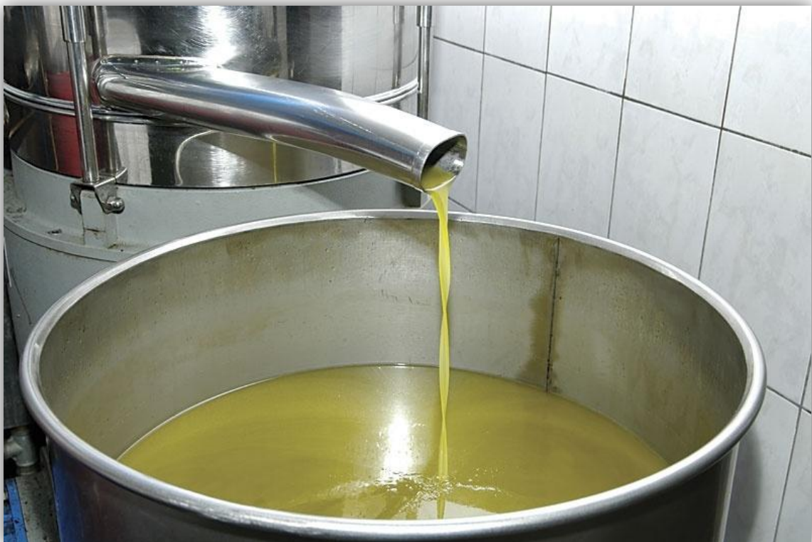
Slika 4 Izdvajanje ulja iz maslinovog tijesta (Zlokić, n.d.).
