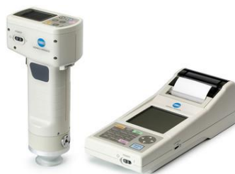
Slika 23 Kromametar Konica Minolta CR-400
