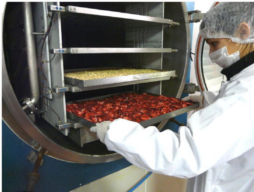
Slika 6 Uređaj za liofilizaciju (web 4)
