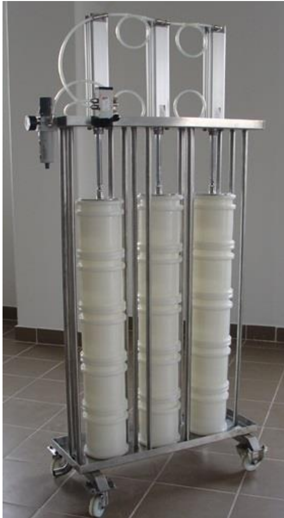
Slika 9 Preša za sir u pogonu malog kapaciteta prerade
