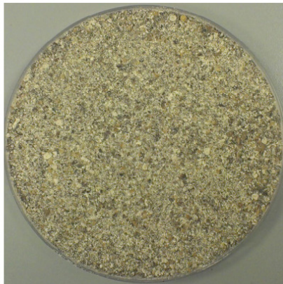
Slika 25. Brašno konoplje poslije ekstrakcije superkričnim CO 2
