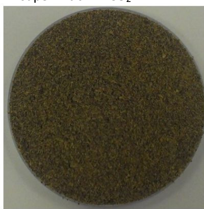
Slika 27. Pogača konoplje nakon prešanja
