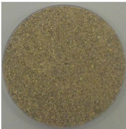
Slika 28. Pogača nakon ekstrakcije superkritičnim CO 2
