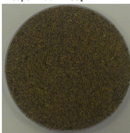
Slika 27. Pogača konoplje nakon prešanja
