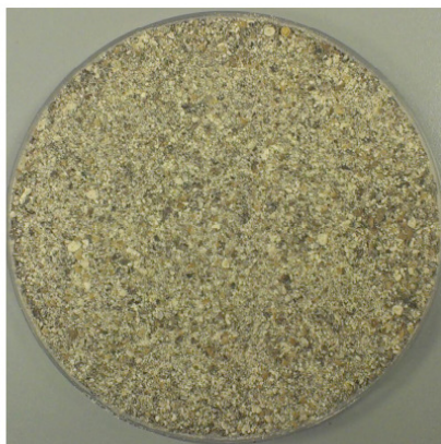
Slika 25. Brašno konoplje poslije ekstrakcije superkritičnim CO 2
