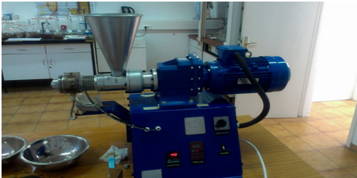
Slika 19. Pužna preša tipa SPU 20
