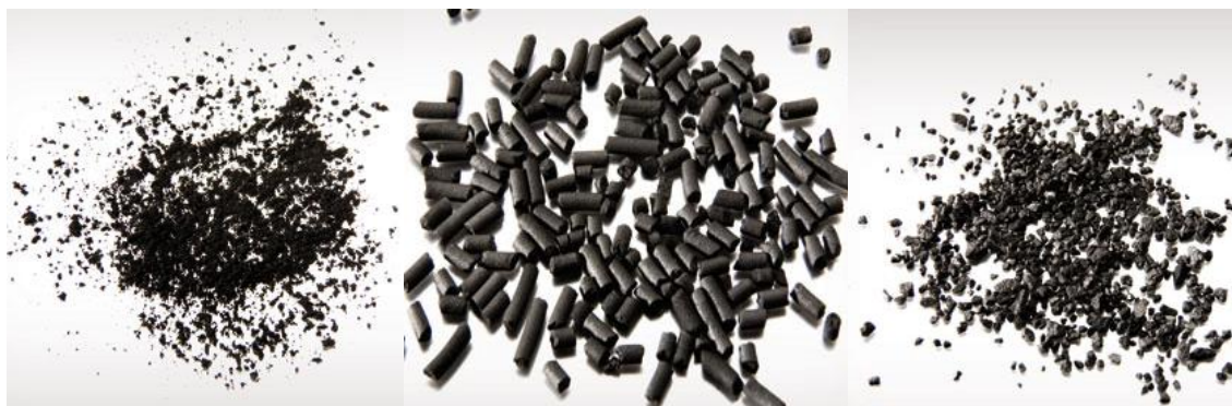
Slika 12 Vrste aktivnog ugljena a. praškasti, b. granulirani – oblikovani, c. granulirani – neoblikovani (www.norit.com)
