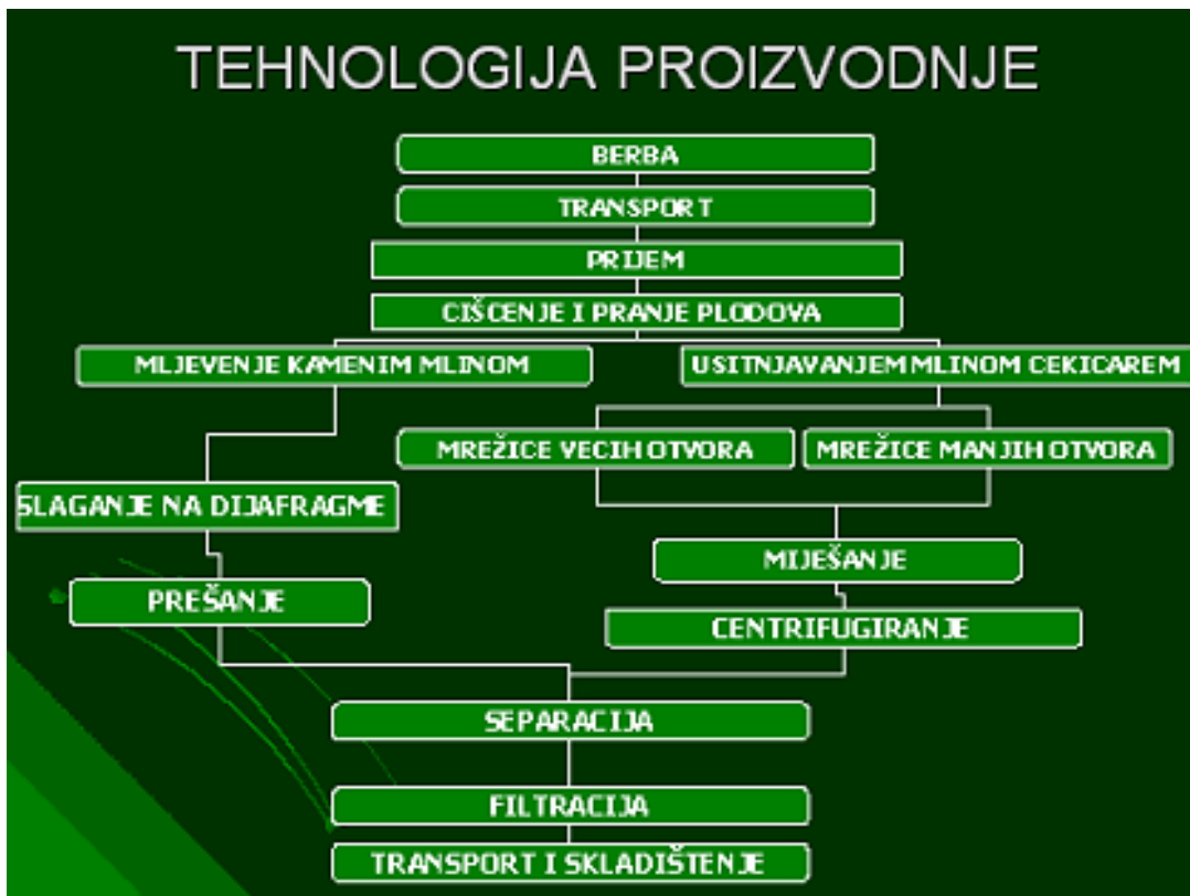
Slika 4. Blok shema proizvodnje maslinovog ulja
