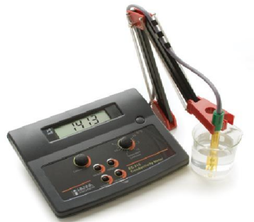
Slika 12 Uređaj za određivanje vodljivosti (konduktometar)
