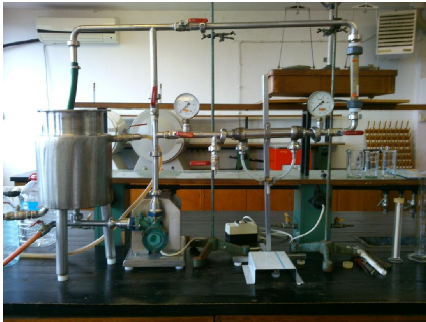
Slika 16 Fotografija laboratorijske aparature za mikrofiltraciju i ultrafiltraciju
