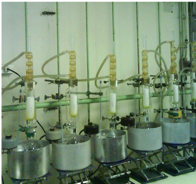
Slika 22 Soxhlet-ova aparatura za ekstrakciju
