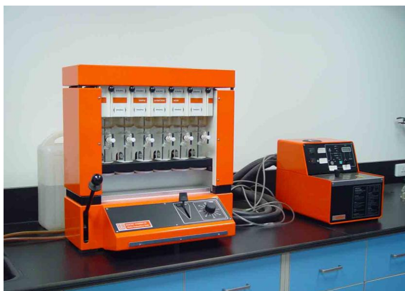
Slika 23 Prikaz uređaja za ekstrakciju ( Soxtec sustav)
