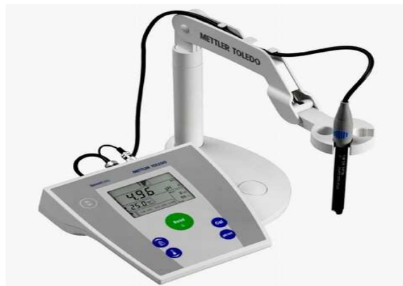
Slika 20. pH-metar „Seven easy“,Mettler Toledo.
