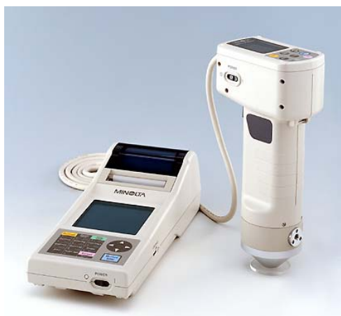
Slika 7. Uredaj za mjerenje boje «CR 400 Konica Minolta»
