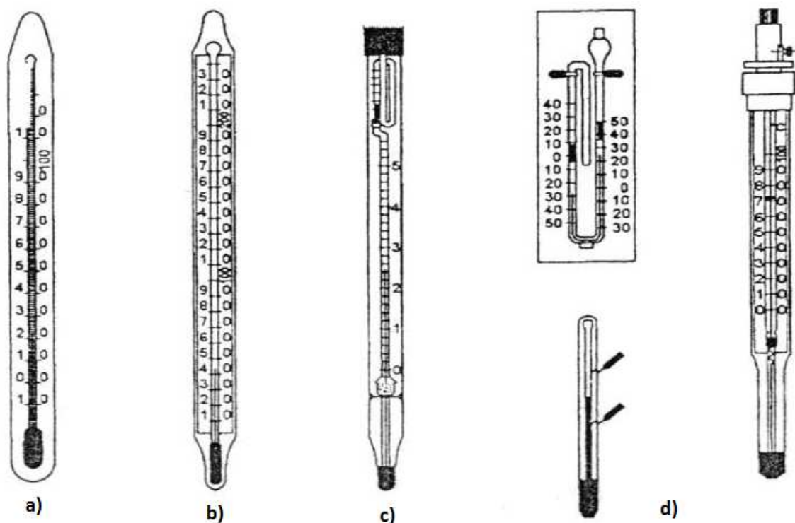
Slika 2 Stakleni kapljevinski termometri: a) štapni termometar, b) termometar sa uloškom, c) Beckman termometar, d) maks.-min. termometar (Zaimović-Uzunović, 2006.).
