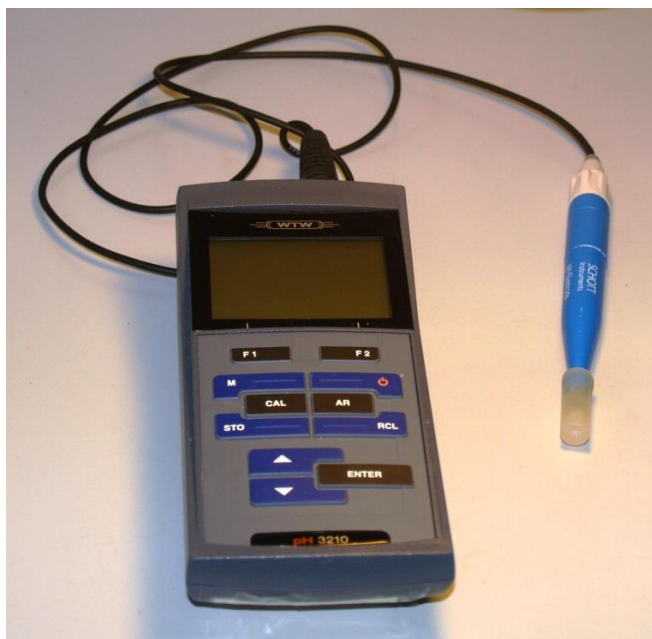
Slika 14. Prijenosni pH metar pH 3210/3310 tvrtke WTW
