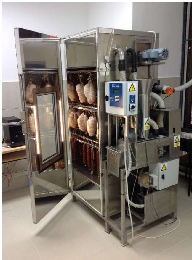
Slika 12 Automatizirana komora za zrenje kulena
