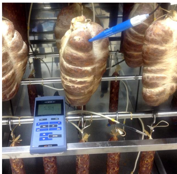
Slika 3 Određivanje pH vrijednosti kulena
