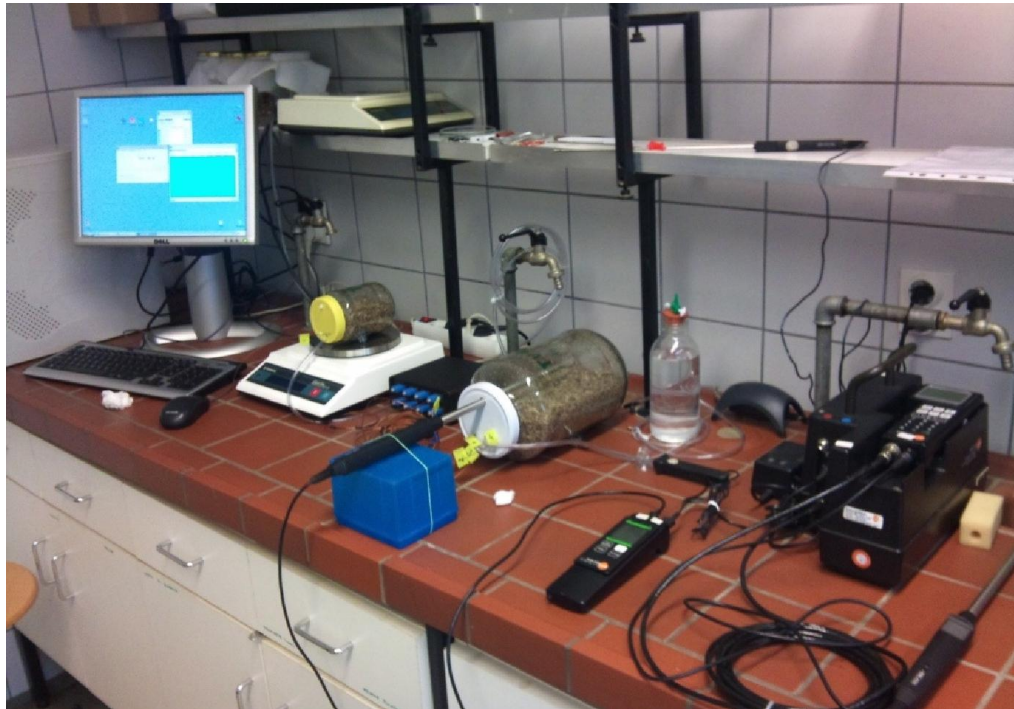
Slika 11 Prikaz horizontalno-cilindričnog staklenog reaktora i opreme
