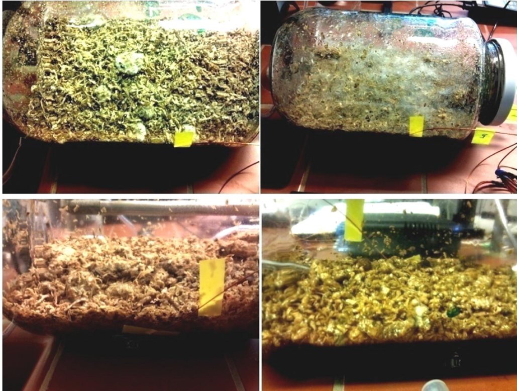
Slika 19 Prikaz supstrata tijekom fermentacije i rast gljive bijelog truljenja
