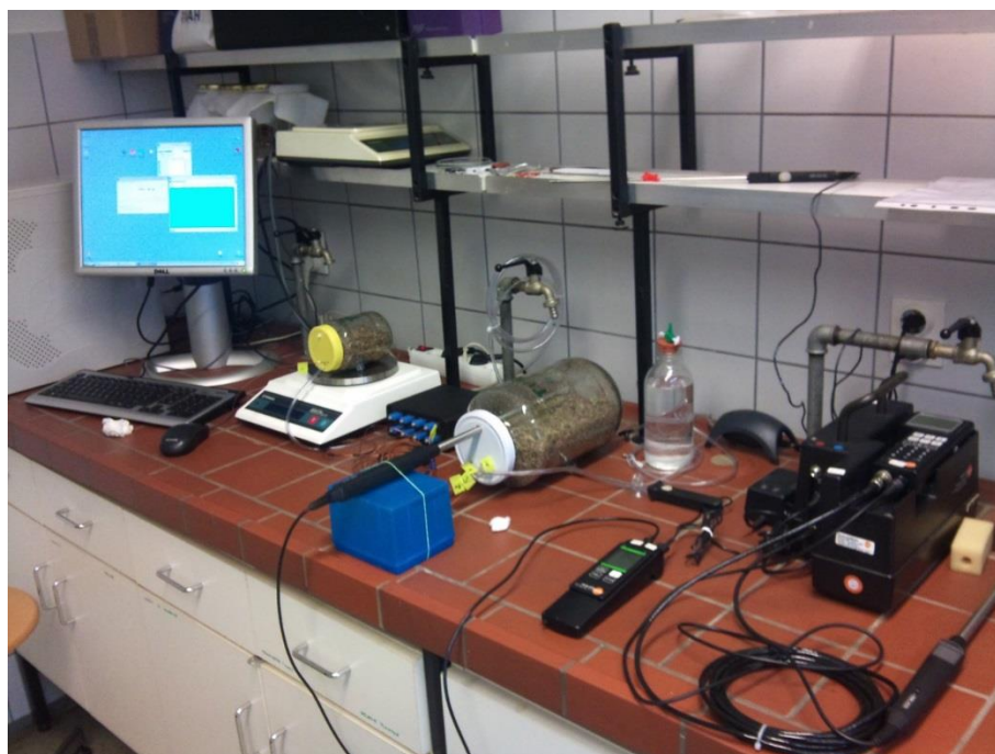
Slika 19 Prikaz horizontalno-cilindričnog staklenog bioreaktora i upotrijebljene opreme
