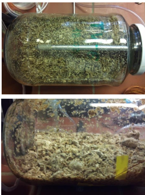
Slika 21 Uzgoj gljive bijelog truljenja T. versicolor TV 6 u horizontalno-cilindričnom staklenom bioreaktoru (HBR)
