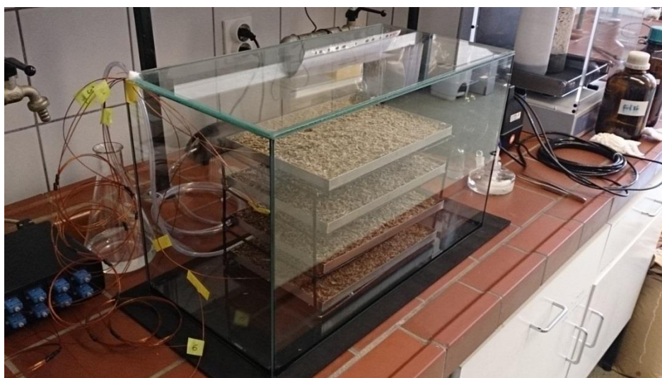
Slika 20 Prikaz laboratorijskog bioreaktora s pliticama i upotrijebljene opreme
