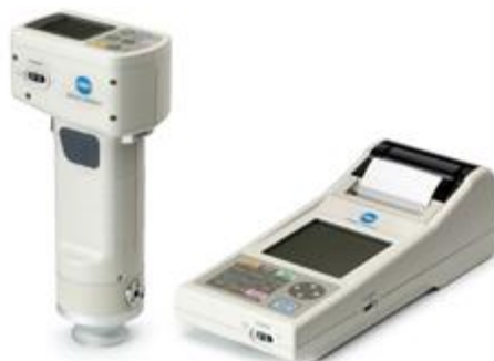
Slika 4. Kolorimetar (Konica Minolta Chroma Meter CR-400)
